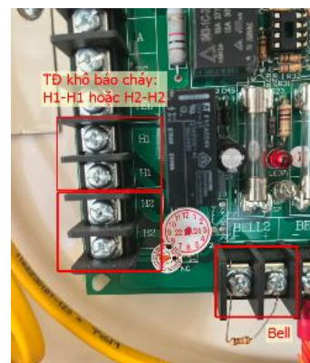
Hình ảnh mạch điều khiển bên trong tủ
